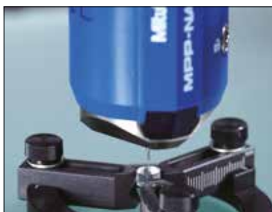
Mesure de forme asphérique avec MPP-NANO
