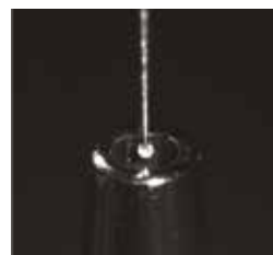
Mesure avec le micro-stylet MPP-NANO
