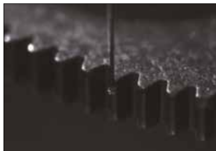
Utilisation du stylet MPP-NANO de \varnothing 125 \mu\text{m}
