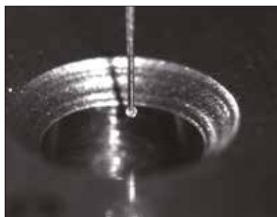
Vue du stylet MPP-Nano depuis la caméra d'observation
