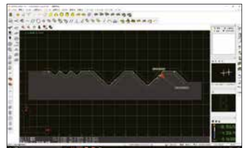
SCANPAK comparaison profil mesuré/profil nominal CAO
