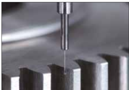
Mesure d'un pignon étalon de module de 0,8
