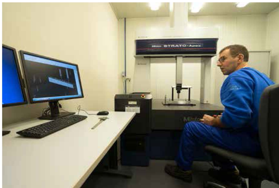
De Strato-Apex van Mitutoyo haalt een nauwkeurigheid van 0,9 \mu .
